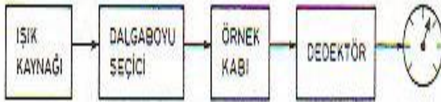
Şekil 3.2 Genel spektrofotometre düzeneği
